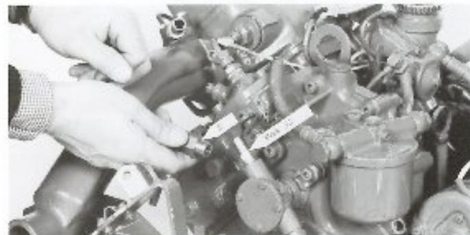
4. Demontera det avkapade röret från sjövattenpumpen samt O-ringsanslutningen E på sjövattenpumpen. Montera rak slanganslutning R 3/8"×5/8" (pos. 32). Se bild. Använd tätningsmedel i gängorna på punkt 3 och 4.
