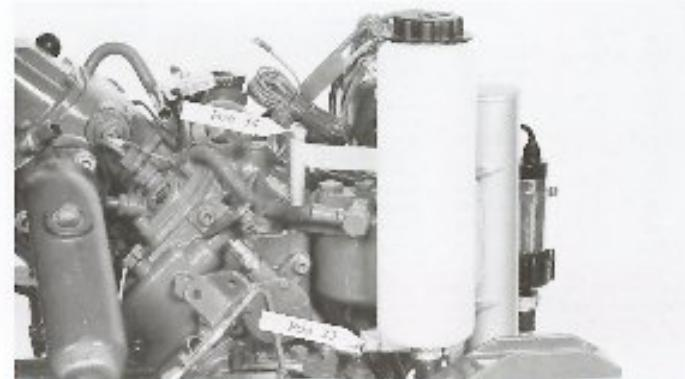
5. Montera värmeväxlarpaketet med M10×90 mm (pos. 34) skruv vid bränslefiltret samt M8×120 mm (pos. 33) skruv vid motorblocket. Elpum-
